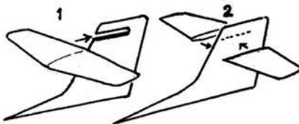
Dos maneras de ensamblar el estabilizador:
